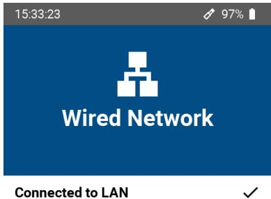
Como alternativa, también puede conectar el XL3 a una red LAN por cable enchufando un cable Ethernet mediante adaptador al conector USB-C.
