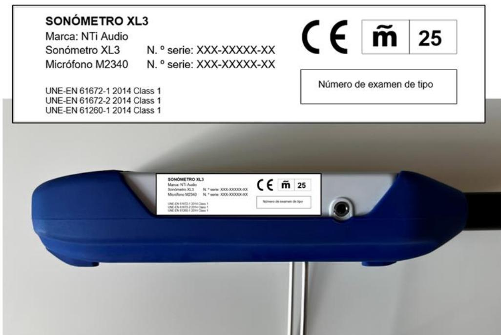
El marcado de conformidad es indeleble y el soporte sobre el que está impreso es resistente para garantizar su durabilidad.
